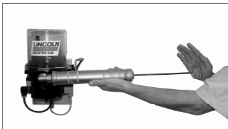
Рис. 18 Заправка резервуара насоса.
